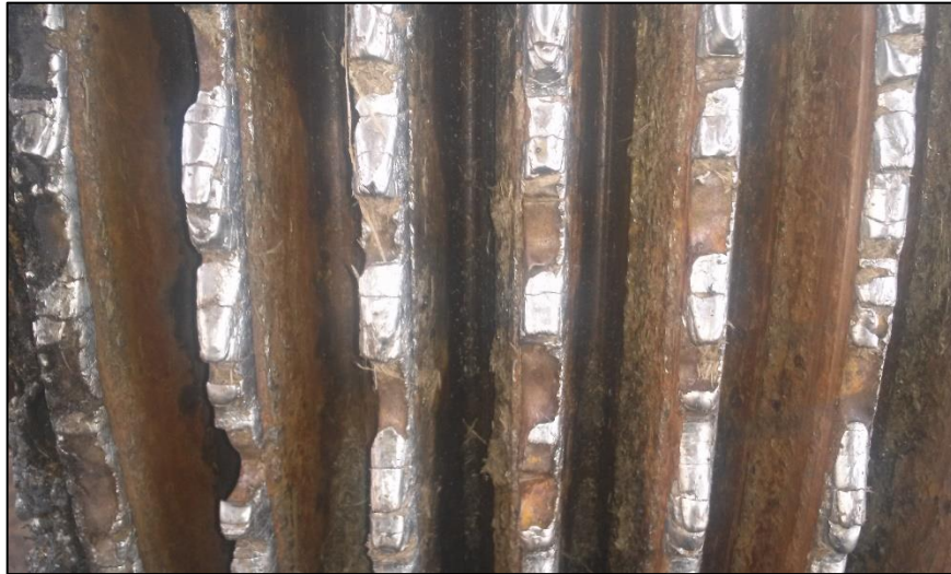
FIGURA 2 – Efeito abrasivo ocorrido nos rolos
